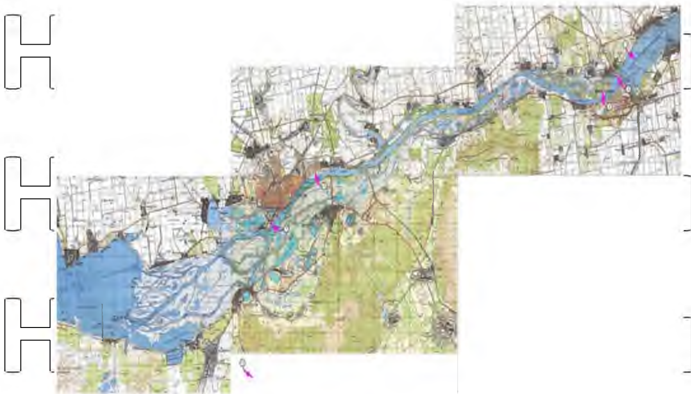
Рис.1.4. Схема розташування постів спостережень мережі гідрометслужби України у верхньому і нижньому басейнах Каховського водосховища.
