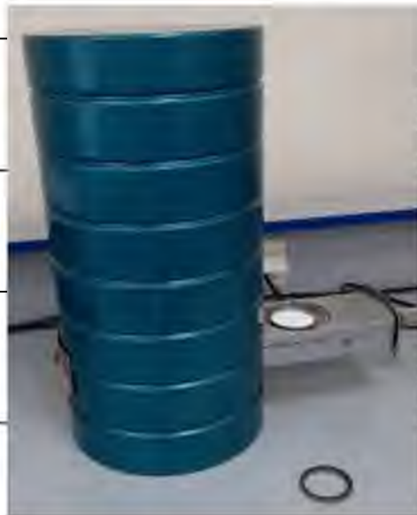
Рис.2.1.3. Установка малого фону ADCAM-300
