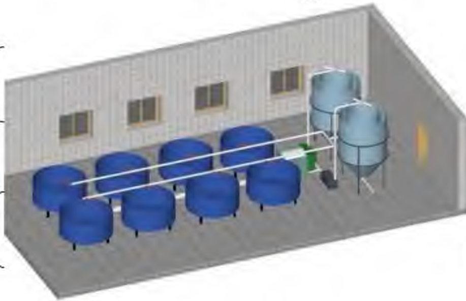
Рис. 3.2.1. Схема УЗВ з 2-модулів
