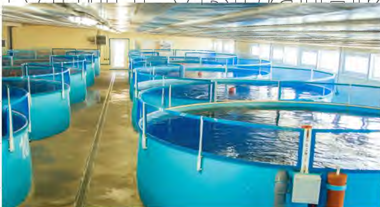
Рис. 3.2.1. Басейни установки замкнутого водопостачання (рибницька УЗВ)
