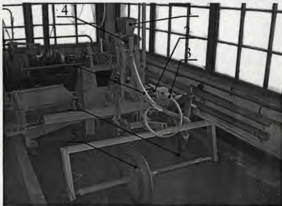
Рис. 3.6. Загальний тип лабораторної установки в ґрунтовому каналі. 1 - бункер для насіння; 2 - вентилятор з приводом; 3 - повітропровід; 4 - сівалка; 5 - льодовий каток; 6 - насіннепровід; 7 - сошник лапи з дистриб'ютором
