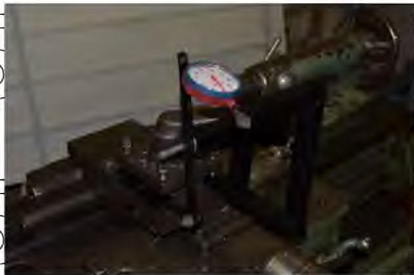
Рис. 3.8. Лабораторна установка для вимірювання радіальної складової сили різання P_y
