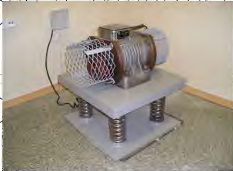
Рис. 3.10 Стенд для випробувань підшипникових вузлів під час циклічного навантаження
