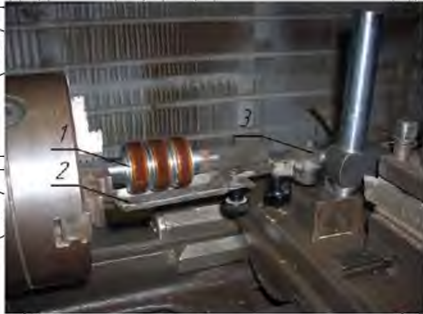
Рис. 3.2. Лабораторна установка для нанесення полімерних покриттів.
