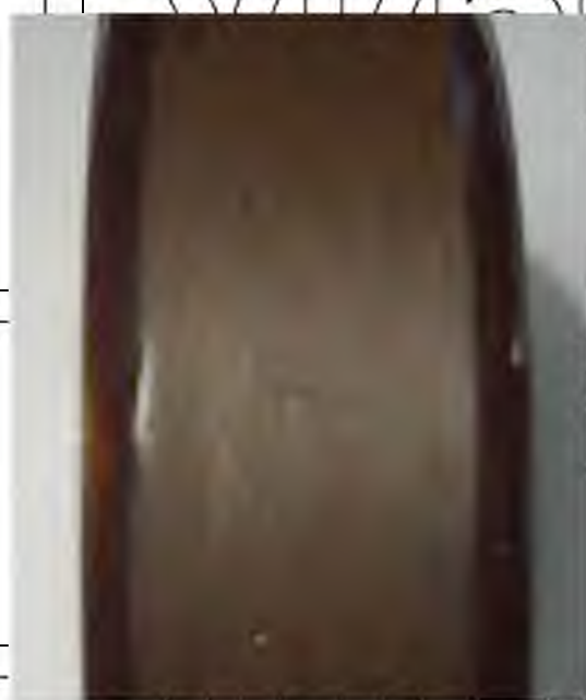
Рис. 4.5. Полімерне покриття з еластомеру Ф-40С після обробки різцем ВК-8 при частоті обертання n = 2000 хв -1 та подачі S = 0,08 мм/об.
