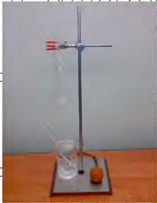
Рис. 3.1. Пристосування для вимірювання кінематичної в'язкості розчинів еластомеру Ф-40С (віскозиметр ВПЖ-2)
