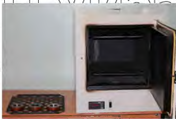
Рис. 3.5. Сушильна шафа СНОЛ-3.5,3.5,3.5/3 та підшипники з полімерним покриттям після термічної обробки
