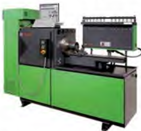
Рисунок 3.1 Загальний вигляд стенда EP3 815 з безмензурочною електронною вимірювальною системою КМА 802 та до оснащенням для CR: 1 - вимірювальна система КМА 802;
