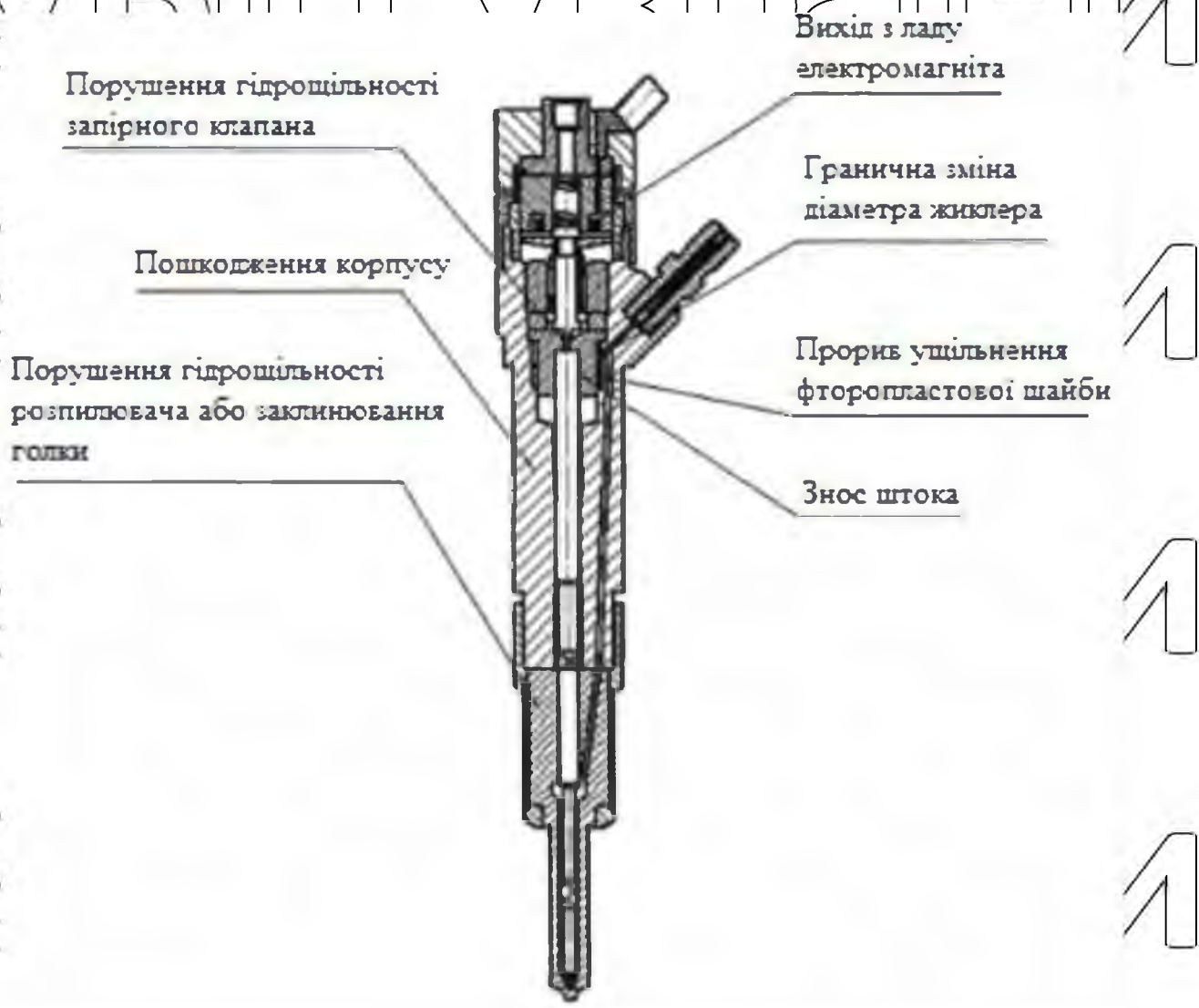
Рисунок 1.7 Топографія основних несправностей ЕГФ фірми Bosch
