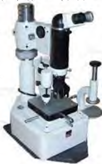
Рисунок 3.6 Загальний вигляд: а) твердоміра Віккерса моделі ПП-7р-1; б) мікротвердоміра ПМТ-3
