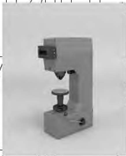
Рисунок 3.6 Загальний вигляд: а) твердоміра Віккерса моделі ПП-7р-1; б) мікротвердоміра ПМТ-3
