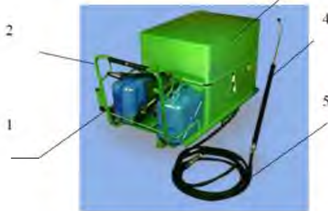
1 - ємність для мийочого розчину, 2 - ручка для переміщення, 3 - корпус установки, 4 - гідромонітор, 5 - шланг високого тиску.
