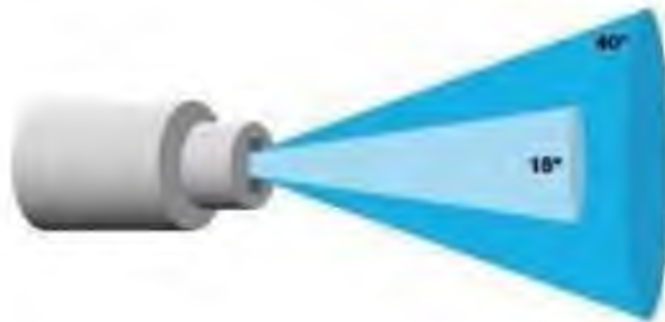
Рис. 2.2 Ступінь насиченості водного струменя в залежності від кута її розпилу Енергія, яка виходить із сопла струменя визначається з виразу:
