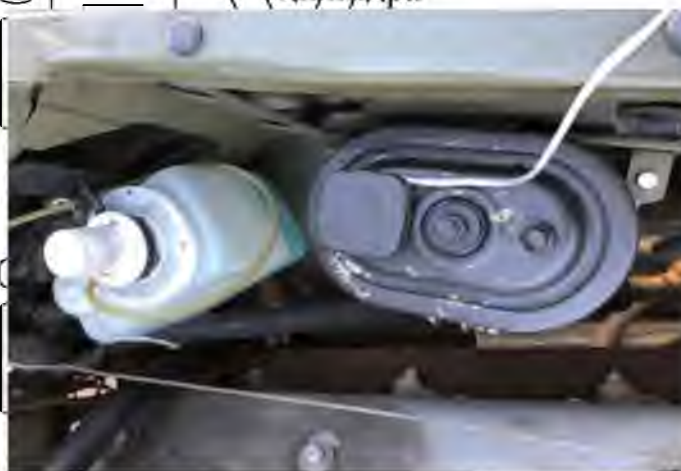
Рис. 3.8 - Місце вимірювання температури робочої рідини у бачку насосу
