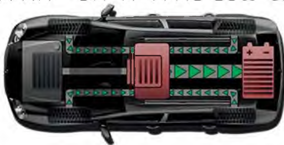
Рисунок 1. – Схема системи рекуперації гальмівних сил для автомобіля Porsche
