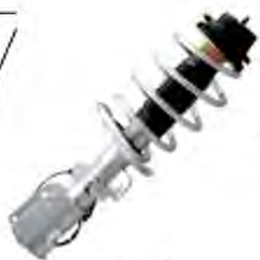
Рисунок 1.5 – Передня стійка Magneti Marelli SD з амортизатором з електромагнітними клапанами
