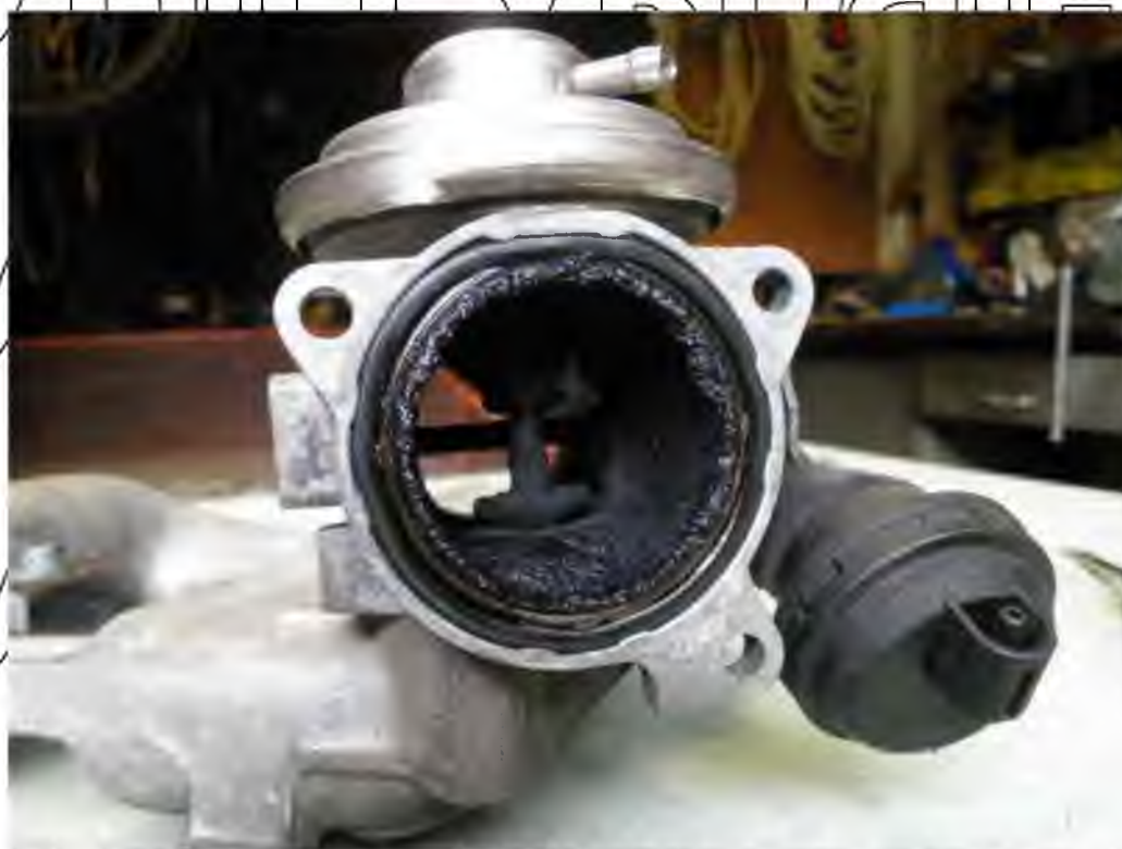
Рис. 1.4 Несправний клапан EGR
