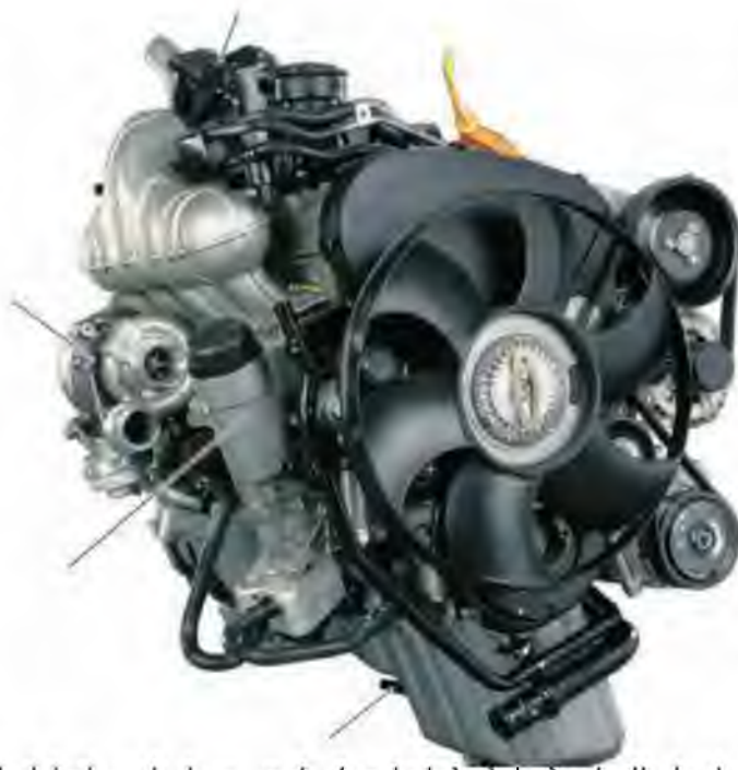
Рис. 3.2 Двигун Volkswagen Crafter
