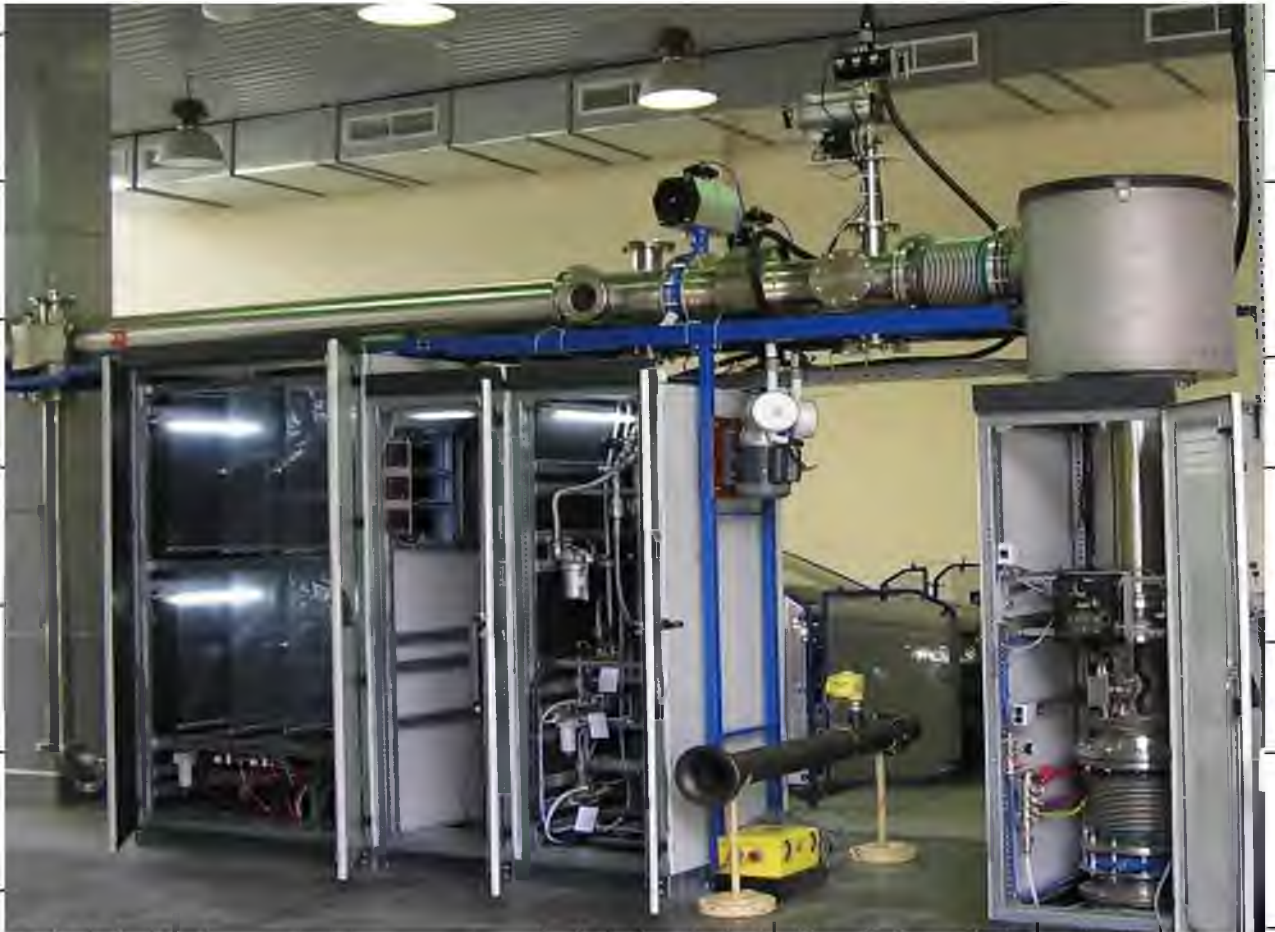
Рис.3.4 Загальний вигляд основної частини елементів вітнизняної системи CVS моделі EMMS-CVS-010
