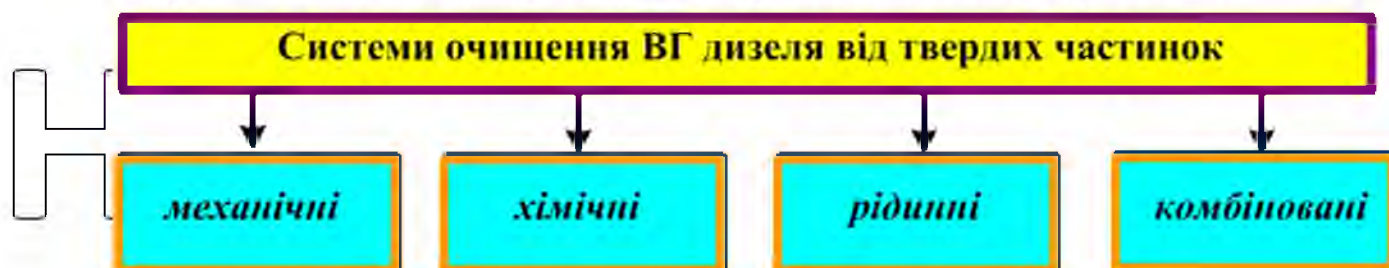
Рис. 2.5 Системи очищення відпрацьованих газів дизеля від твердих частинок
