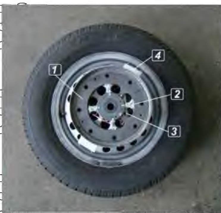
1 – вимірювальне кільце; 2 – тензорезистор з захисним шаром герметика; 3 – підстроювальна плата; 4 – блок живлення
