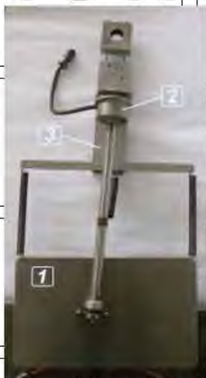
1 – опорна поверхня; 2 – вимірювальний пристрій; 3 – кріпштейн для кріплення пристрою на крилі та капоті автомобіля
