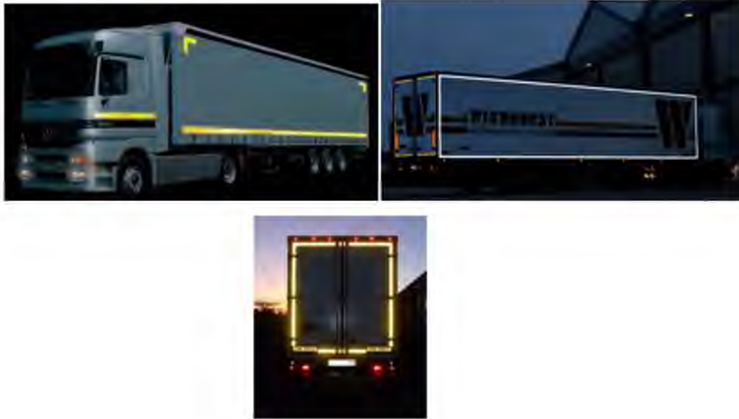
Рис. 4.1. Підвищення безпеки шляхои використання світловідбиваючої стрічки
