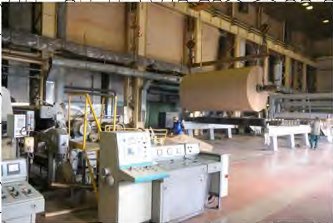
Рис. 1.4. Формуючі і пресові картоноробні машини рулонного типу
