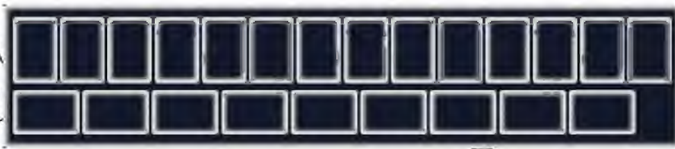
Рис. 2.1 Схема сформованого транспортного пакета 24 європалети
