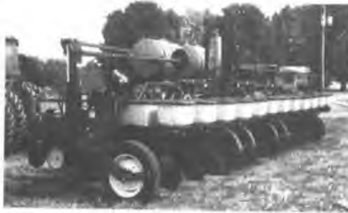
Рис 1.10 Сівалка з програмованою нормою висіву з набором пристроїв «ACCU-PLANT»
