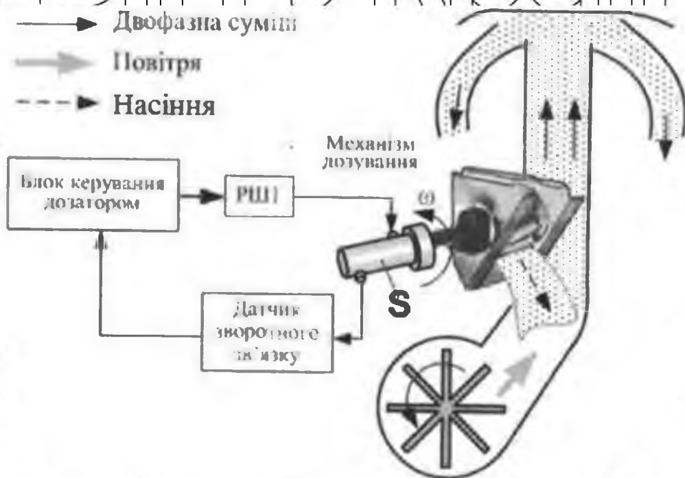
Рис. 2.7. Схема блоку керування центральним дозатором сівалки.
