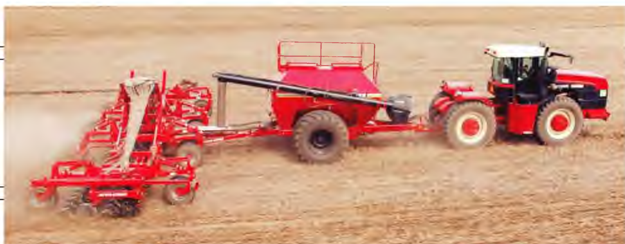
Рис. 2.2. Посівний агрегат (MF 8470 + TURBOSEM II)
