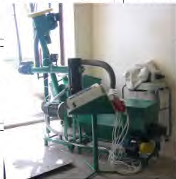
Рисунок 2.6. Обладнання ЕКО-БІО-100 для виробництва паливних гранул.
