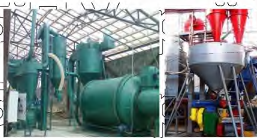
Рисунок 2.7 Лінія грануляції соломи на базі ОГМ-1,5
