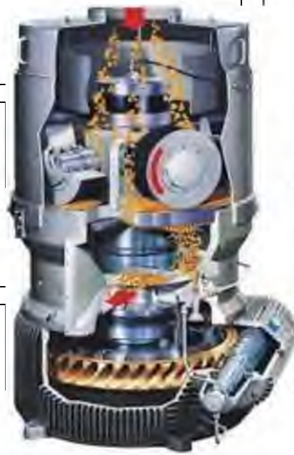
Рисунок 2.9 Гранулятор з плоскою матрицею
