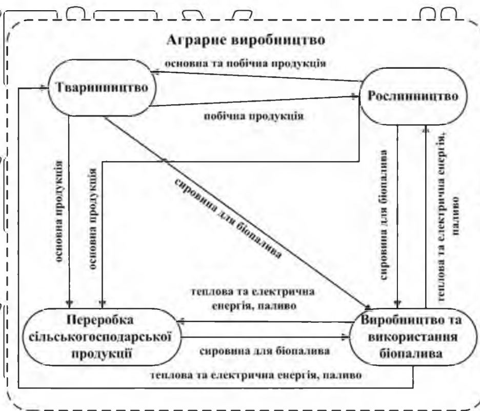
Рисунок 1.1. Місце виробництва та використання біопалива у виробничій діяльності сільськогосподарського підприємства
