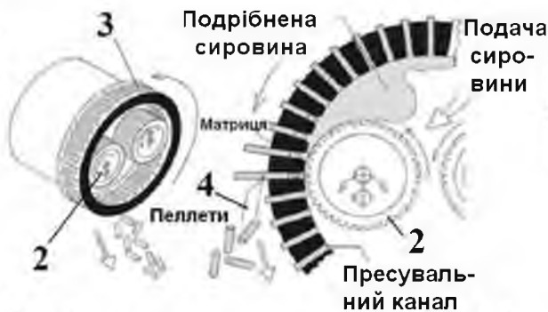
Рисунок 2.3. Принцип роботи прес-гранулятора з круглою матрицею [www.pellets.ru]. а – загальний вигляд прес-гранулятора з круглою матрицею; б – кругла матриця; в – схема роботи круглої матриці; 1 – шнек; 2 – каток; 3 – кругла матриця; 4 – ніж; 5 – стрічковий транспортер
