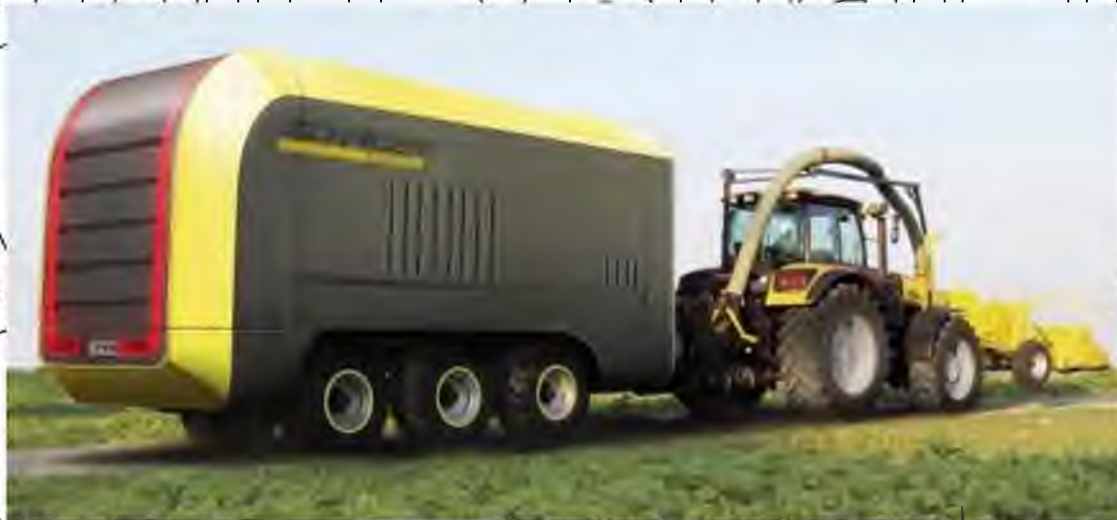
Рисунок 2.19 Мобільний заготівельник пелет Schaidter Pelletec D 8.0 Даний агрегат працює таким чином.
