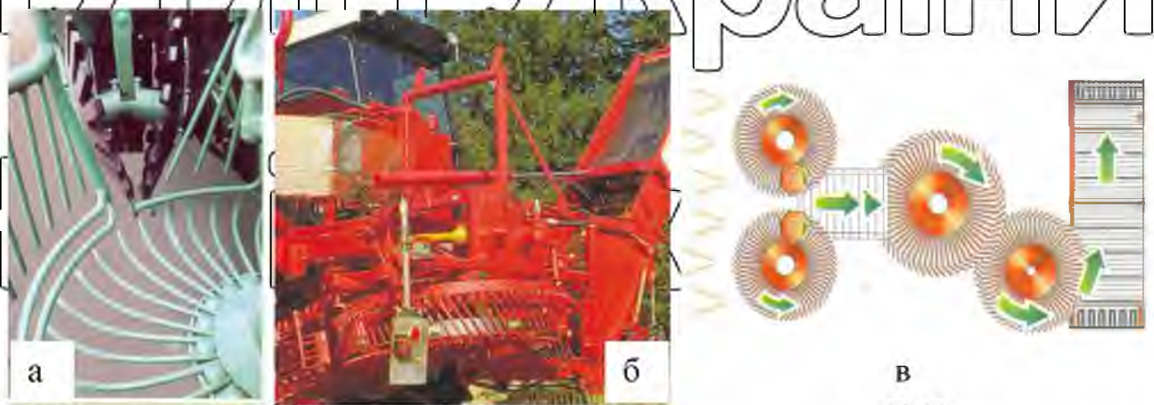
Рис. 1.5 Загальний вигляд транспортного (а), доочисного (б) конструктивно-технологічна схема (в) транспортно-очисного роторного очисника
