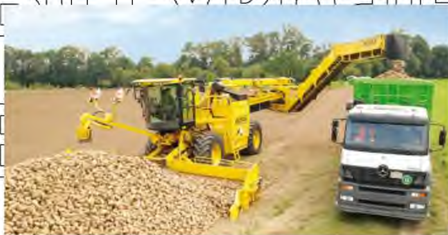
Рис. 2.6. Навантаження цукрових буряків очищувачем-навантажувачем Euro-Maus3 (ROPA).
