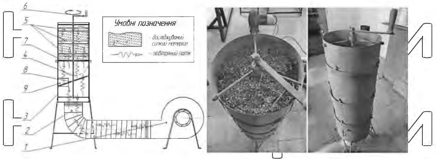
Рис. 2.2. Установка для проведення дослідження вентиляції матеріалу повітряним потоком: 1 - вентилятор; 2 - гнучкий повітропровід; 3 - циліндрична камера; 4 - вал; 5 - лопаті; 6 - рукоятка; 7 - перфороване дно з механізмом вивантаження; 8 - перфорована похила поверхня; 9 - вивантажувальне вікно
