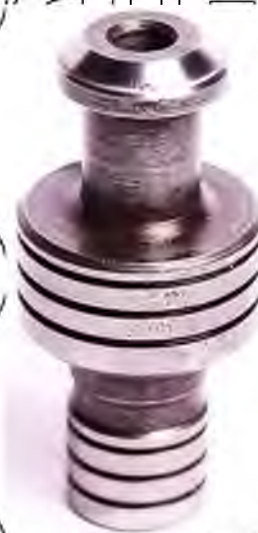
Рис. 1.9. Перепускний клапан з зношенням ущільнювальної поверхні.
