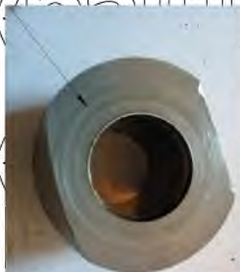
Рис.1.6. Гідроабразивне спрацювання торця втулки насоса НШУ
