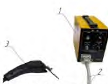
Рис. 3.4. Загальний вид модернізованої установки «ALIER-31» 1 – генератор; 2 – кабель; 3 – електромагнітний вібратор.
