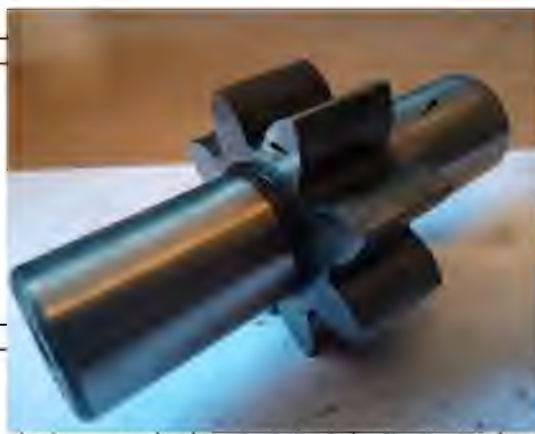
Рис.1.7. Гідроабразивне зношення цапф шестерні і горця.
