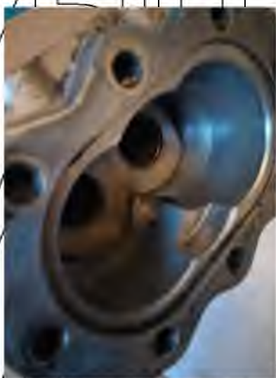
Рис.1.5. Гідроабразивне зношення колодязя корпусу насоса модифікації НШ-У
