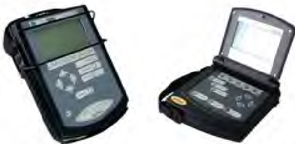
Рис. 2.6. Аналізатори вібрації, зліва направо: "КВАРЦ" "ТОПАЗ"
