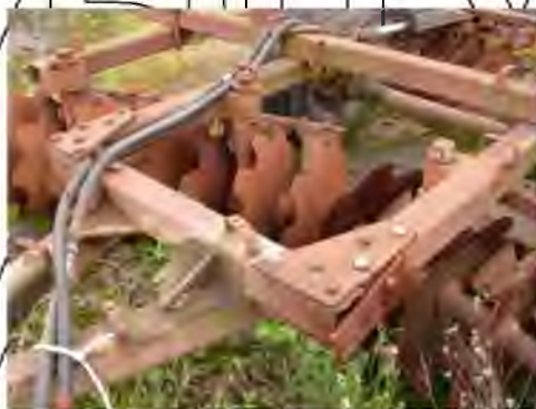
Рис.4.2 Характерні пошкодження з'єднань рами борони
