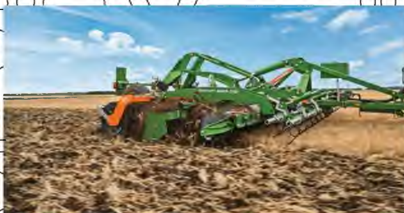
Рис. 1.10 Компактні дискові борони Catros компанії AMAZONE.
