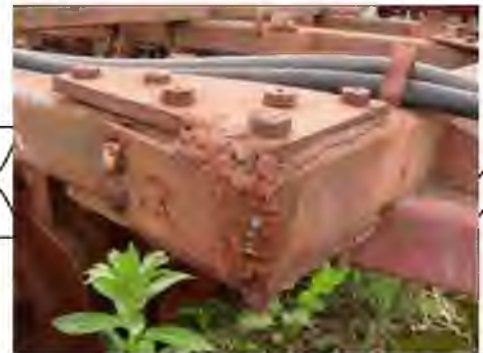
Рис.4.1 Характерні пошкодження зварних конструкцій рами борони
