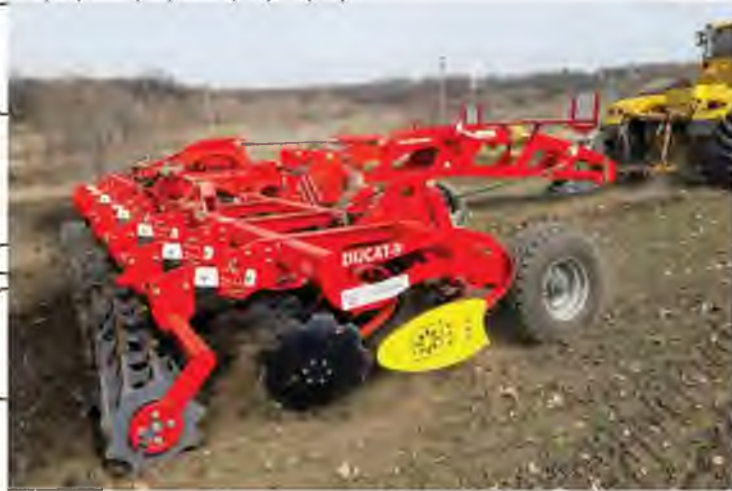
Рис. 1.12 Короткі дискові борони «Дукат» компанії LOZOVA MACHINERY
