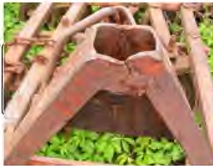
Рис.4.1 Характерні пошкодження зварних конструкцій рами борони
