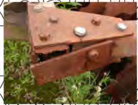
Рис.4.2 Характерні пошкодження з'єднань рами борони
