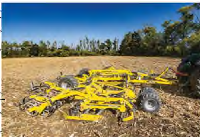
Рис. 1.6. Дисківі ґрунтообробні агрегати чеської компанії BEDNAR
