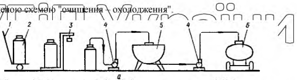
Рис. 2.7. схема лінії первинної обробки молока.
