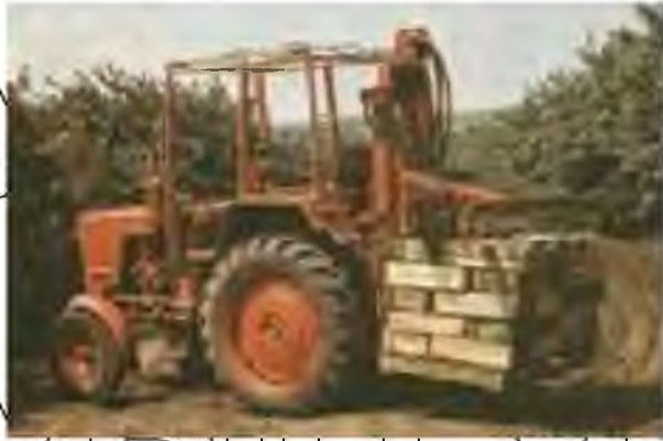
Рис. 2.5 Загальний вигляд навантажувача вилчатого ПВСВ-0,5А в роботі
