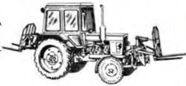
Рис. 2.4 Захват вилочний ЗВ-0,75 с трактором МТЗ-80/82: а) – передня і задня націпка; б) – націпка передня
