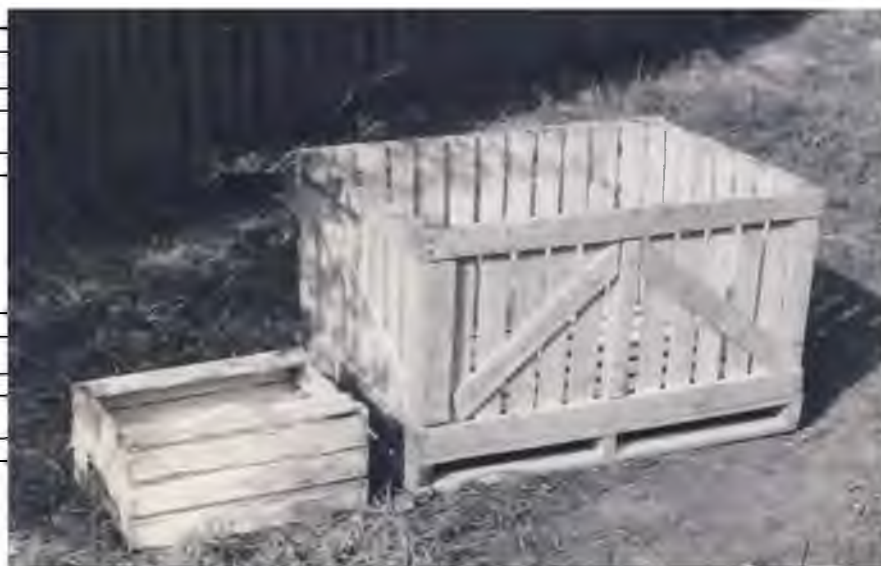
Рис. 1.2 Ящик дерев'яний № 3 и контейнер нерозбірний
