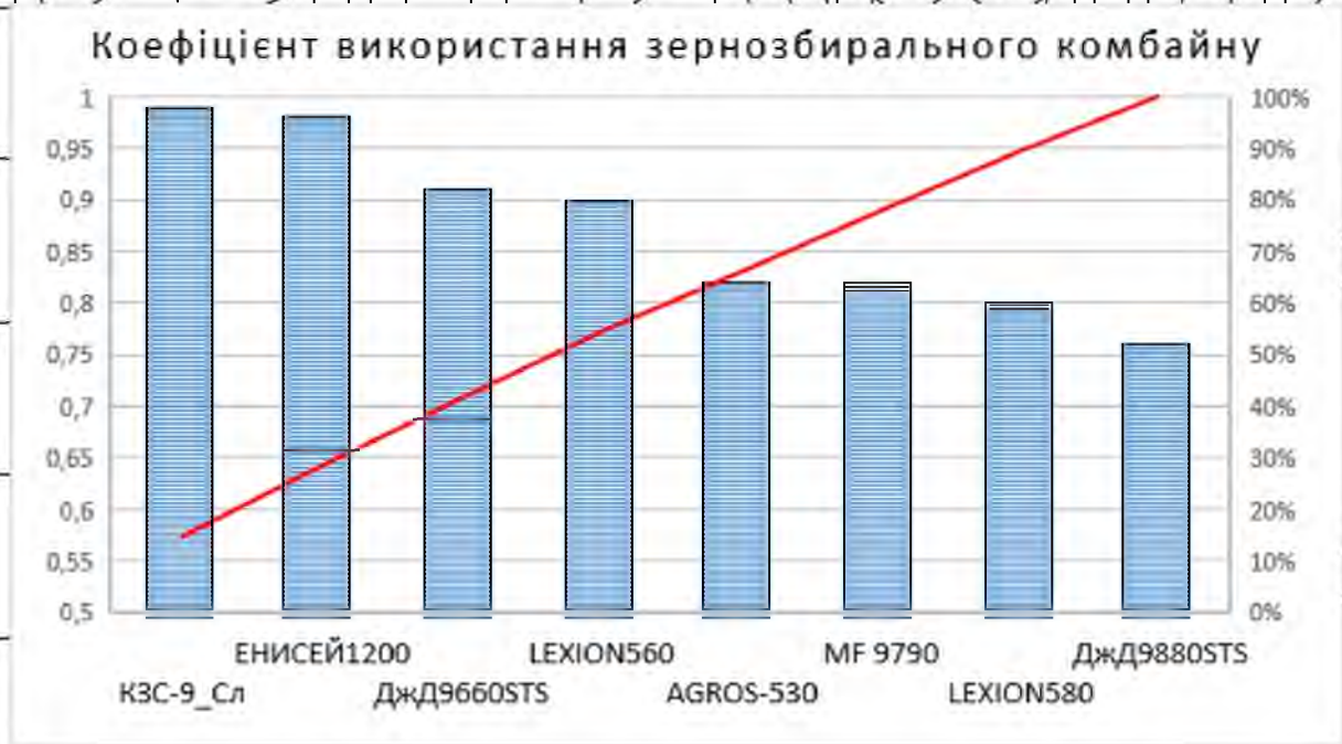
Рис. 3.3. 7. Коефіцієнт використання конкуруючих зернозбиральних комбайнів на збиранні ссі в СФГ «Надія» (пряме комбайнування).
