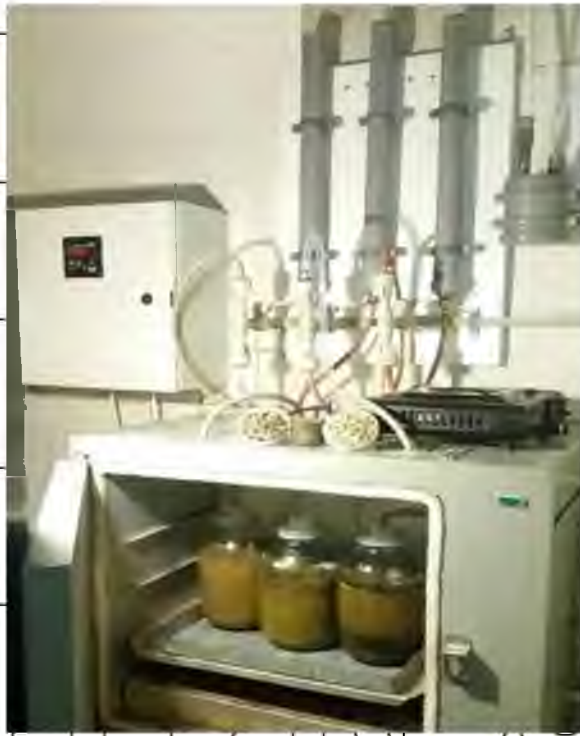
Рис. 3.2. Лабораторна модульна біогазова установка
