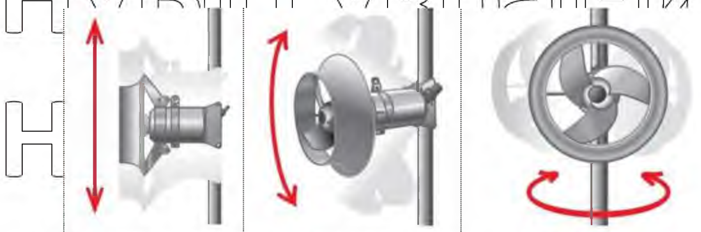
Рис. 2.7. Схема переміщення заглибленої мішалки [30]
