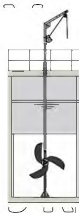
Рис. 2.8. Схема розташування мішалки в метантенку [20]
