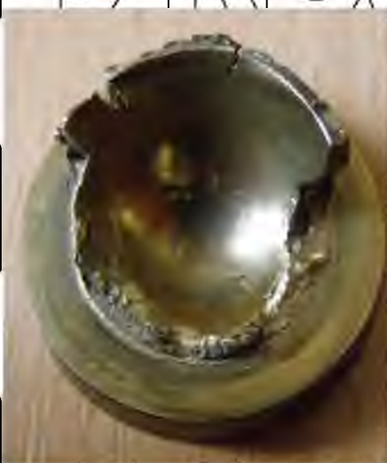
Рис 2.11. Вирив п'яти із заробки плунжера
