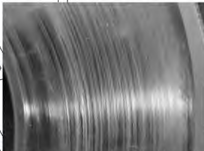
Рис.4.5. Загальний вид зношення похилої
