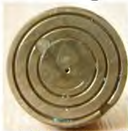
Рис.2.9. Загальний вид зношення п'яти плунжера
