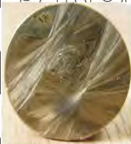
Рис.2.10. Певне зношення кільцевої опори п'яти з завальцюванням отвору гідростатичного підшипника.
