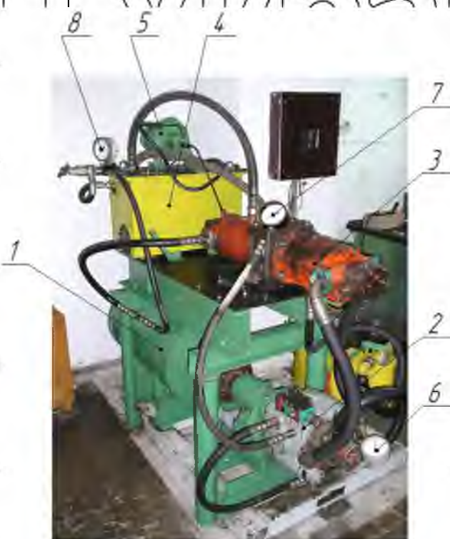
Рис.3.4. Комплексний стенд для експериментальних досліджень гідроприводу трансмісії: 1 – електродвигун; 2 – гідронасос; 3 – гідромотор; 4 – бак; 5 – насосна станція; 6 – манометр заміру тиску в магістралі підпитки; 7 – манометр заміру
