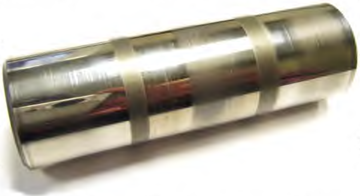
Рисунок 1.3 Поршковий палець двигуна внутрішнього згорання, зношений внаслідок диспергування
