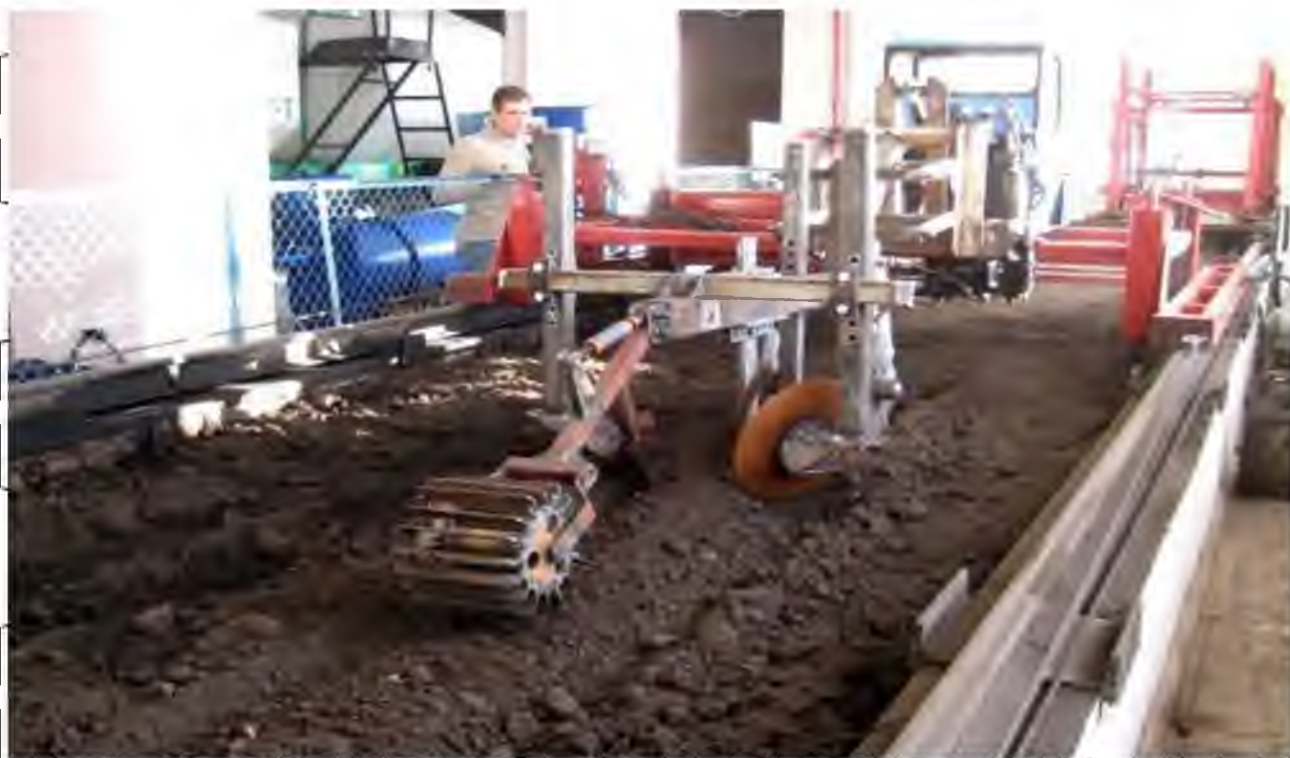
Рис. 3.8. Лабораторна установка для енергетичної оцінки секції культиватора
