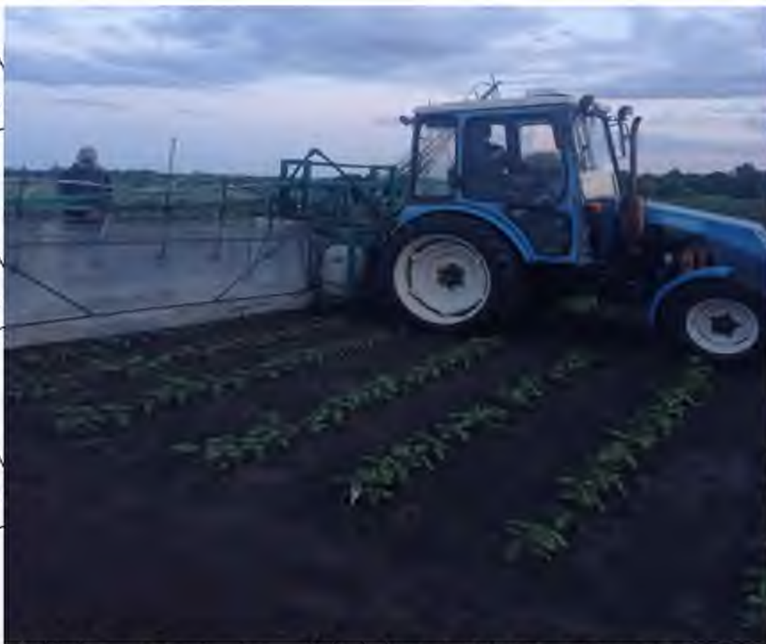
Рис. 2.1. Внесення гербіциду за допомогою трактора ХТЗ 3512 і обприскувача точного виливу
