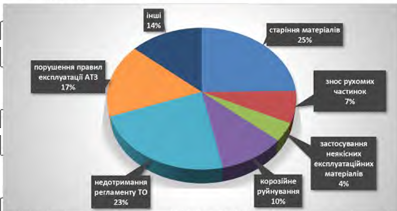
Рис. 2.1 - Діаграма розподілу основних причин експлуатаційних відмов елементів ЕСУД: 1 - старіння матеріалів; 2 - знос рухомих частинок; 3 - застосування неякісних експлуатаційних матеріалів; 4 - корозійне руйнування; 5 - недотримання регламенту ТО; 6 -; 7 - інші
