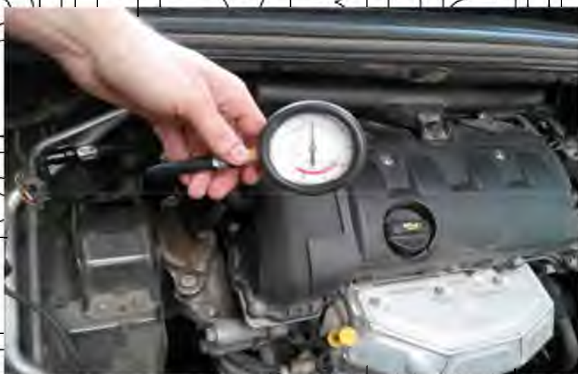
Рис. 4/3 - Перевірка тиску палива на ділянці «паливний фільтр - ПНВТ» двигуна ЕР6 автомобіля
