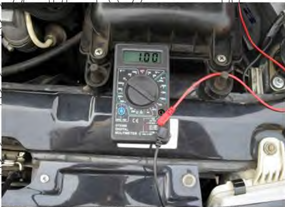
Рис. 4.8. Перевірка електричного живлення датчика положення впускного розподільного валу двигуна D38
