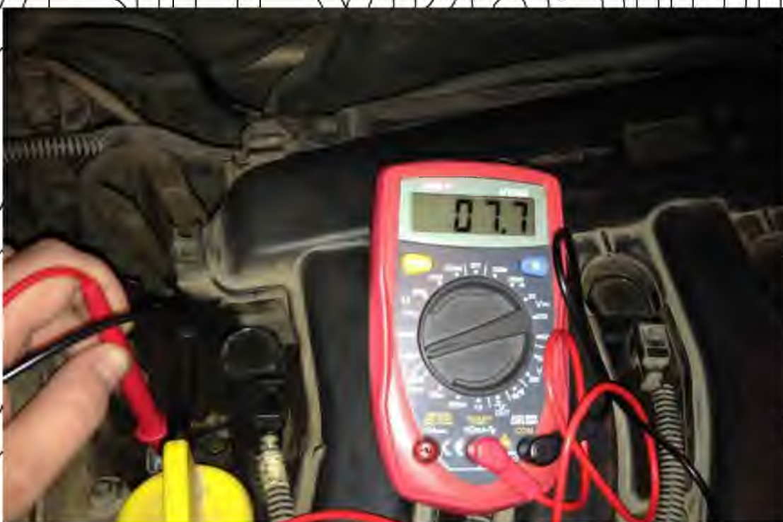
Рис. 4.6. Перевірка керуючого сигналу електромагнітного клапана підсистеми зміни фаз ГРМ випускних клапанів двигуна D38 автомобіля
