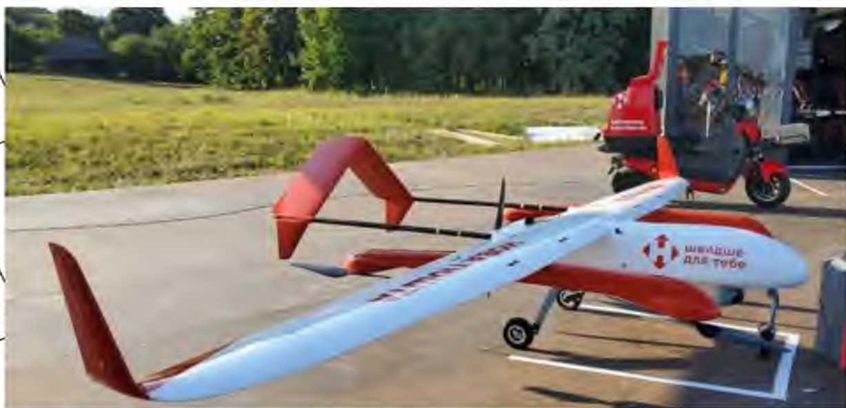
Рис. 2.3 Експериментальний безпілотний літальний апарат з можливістю вертикального зльоту
