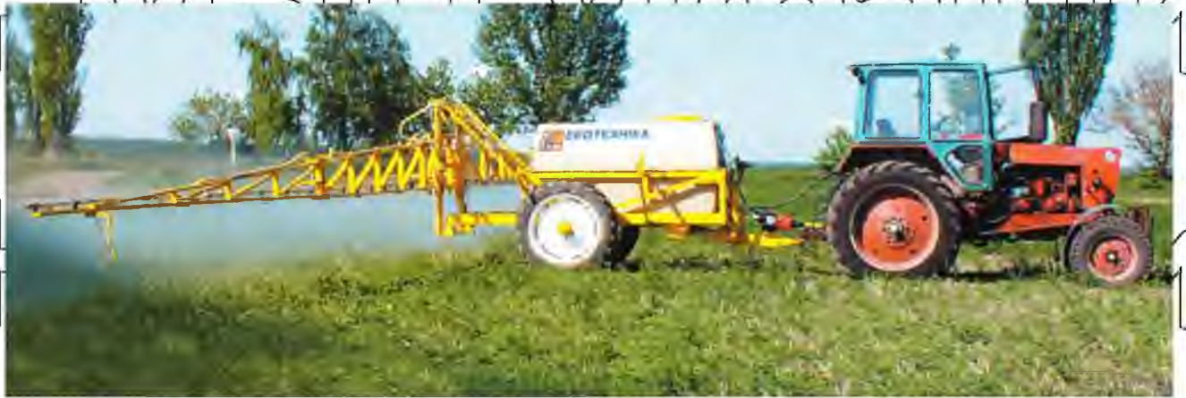
Рис. 2.3. Причінний агрегат для внесення пестицидів (MT3-80.1 + ОПК-2000 (ЕКО))
