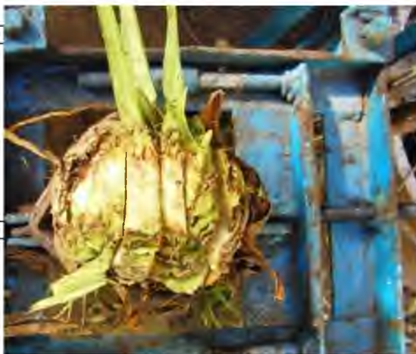
Рис. 4.7. Вигляд головки коренеплоду після взаємодії з копірною частиною робочого органу (головка штучно відновлена після зрізу).
