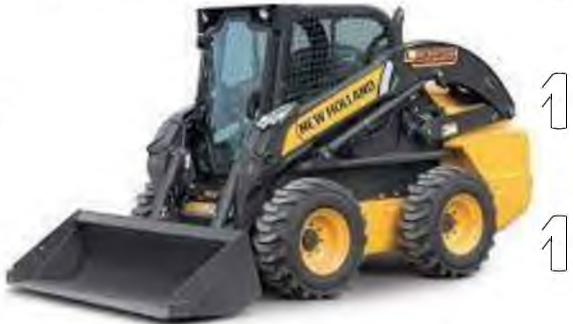
Рис. 1.6. Конструкція двобалочного навантажувача з переднім входом в кабінку.
