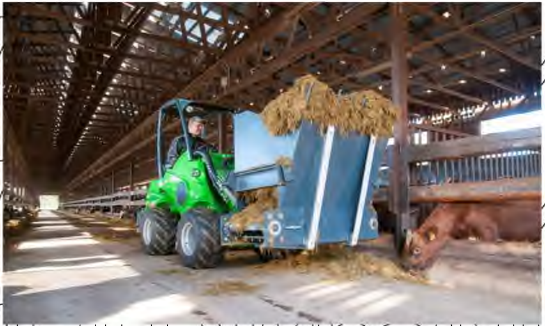
Рис. 1.5. Навантажувач, спеціальний ківш з стрічковим транспортером і гідроприводом.
