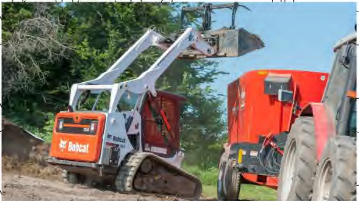
Рис. 2.1. Навантажувачі з боковим поворотом на колісному (а) та гусеничному ході (б)
