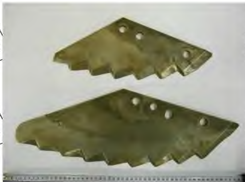
Рис. 4.3. Результат інтенсивного зношування ножа
