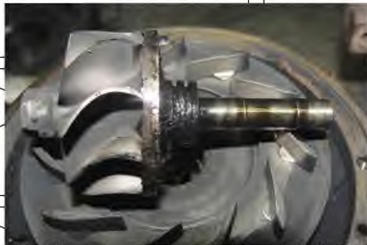
Рис. 3.3. Сліди кольорів мінливості на валу компресорного устаткування
