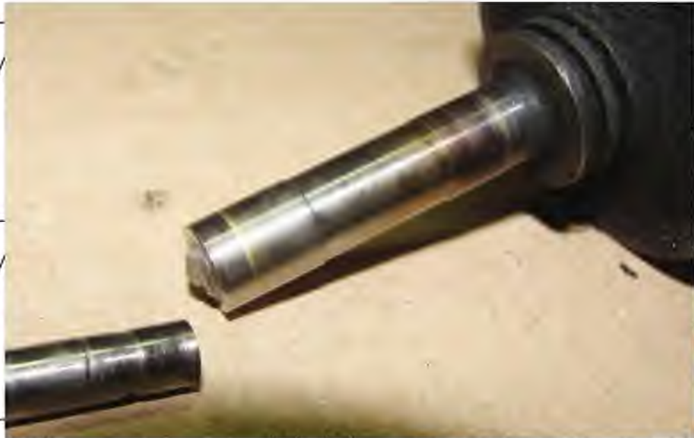
Рис. 3.6. Втомне руйнування валу турбіни
