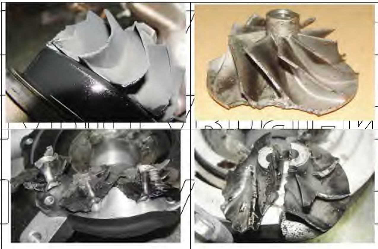
Рис. 3.4. Зношування та руйнування крильчатки
