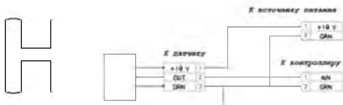
Рисунок 3.9 - Схема підключення датчика положення вікна
