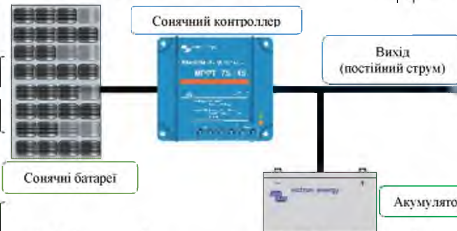
Рис. 3.1 Умовна схема сонячної електростанції автономного типу (постійний струм, DC)
