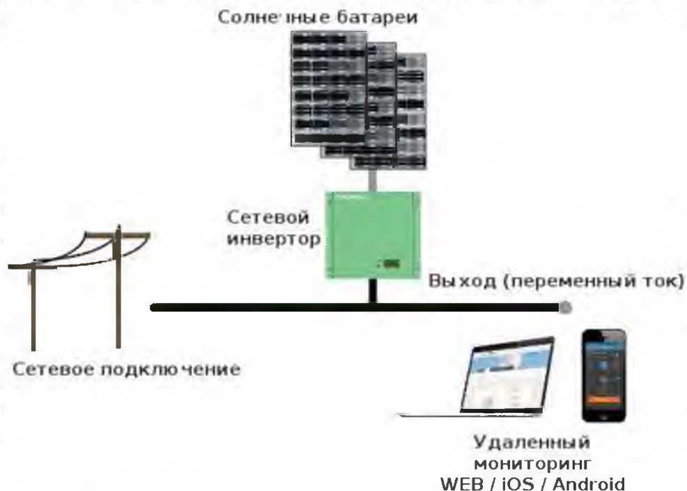
Рис. 3.4. Умовна схема мережевої сонячної електростанції (Змінний струм, АС)
