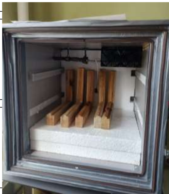
Рис. 3.15. Завантаження зразків у морозильну камеру
