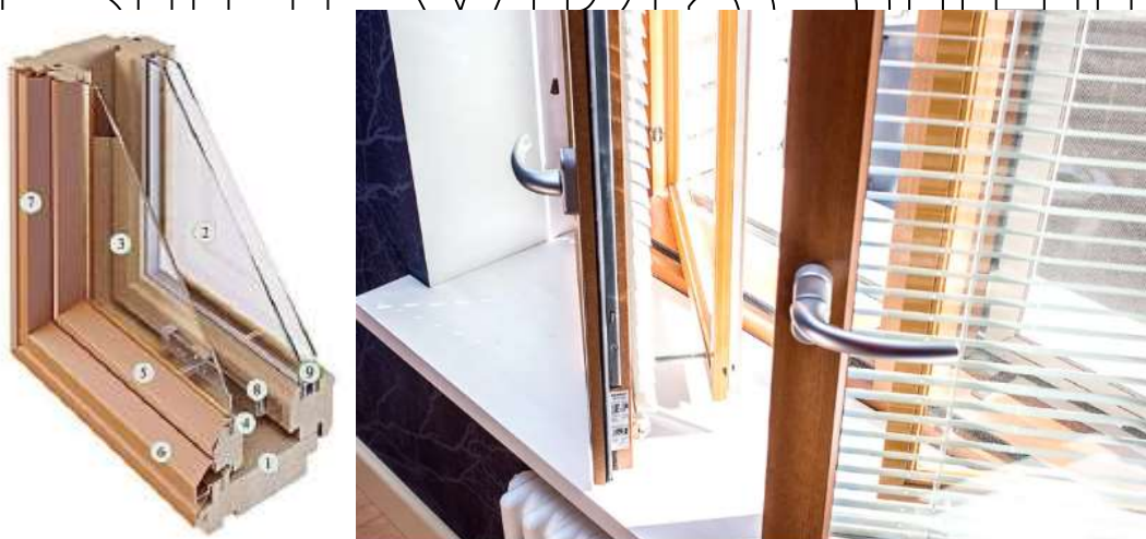
Рис. 1.5. Схема фінського дерев'яного вікна з склопакетом [3, 13]
