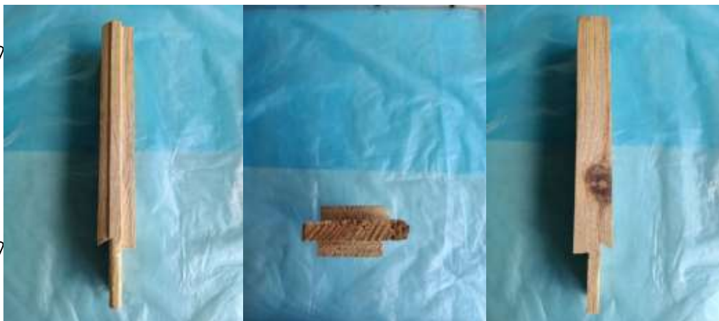
Рис. 3.2. Деталь дерев'яного вікна з шипом
