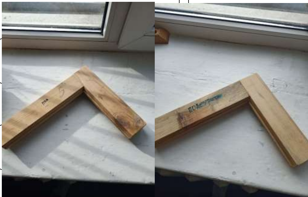
Рис. 3.12. Склеєні зразки поліуритановим клеєм та клеєм ПВА
