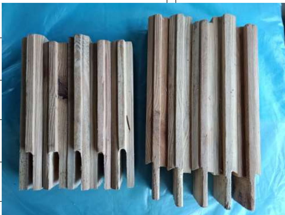
Рис. 2.4. Зразки планок віконних кутів із деревини сосни
