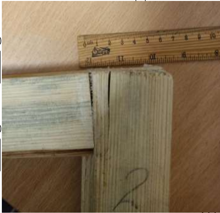
Рис. 3.25. Зруйнований зразок типу «каучук»
