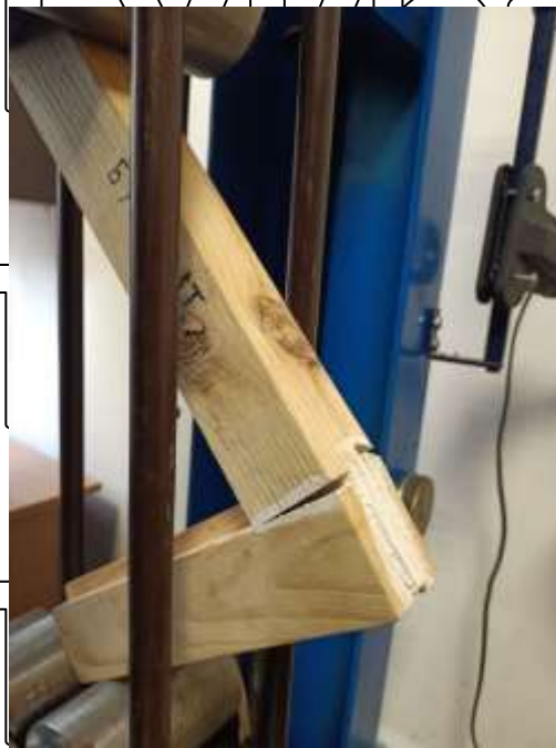
Рис. 3.22. Руйнування зразків типу «Бустилат»
