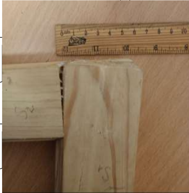
Рис. 3.27. Зруйнований зразок типу «ПВА»
