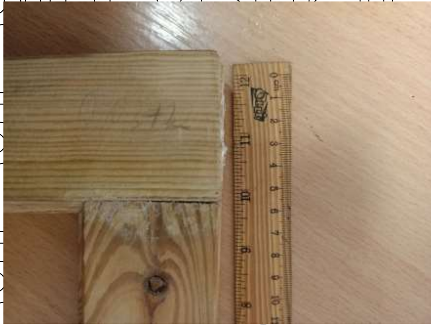
Рис. 3.29. Зруйнований зразок типу «рідке скло»
