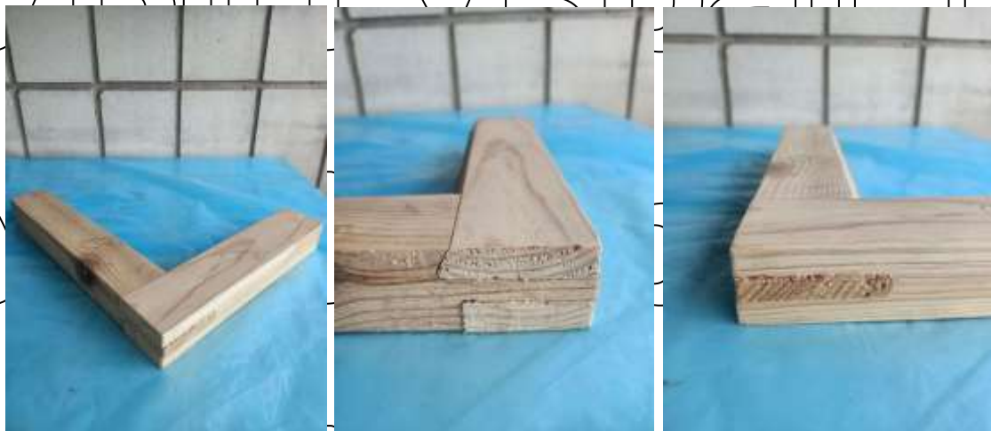
Рис. 3.3. З'єднання деталей на наскрізний одинарний шип
