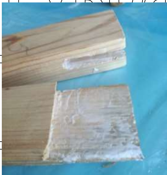
Рис. 3.7. Процес нанесення клею ПВА «Люкс» D4
