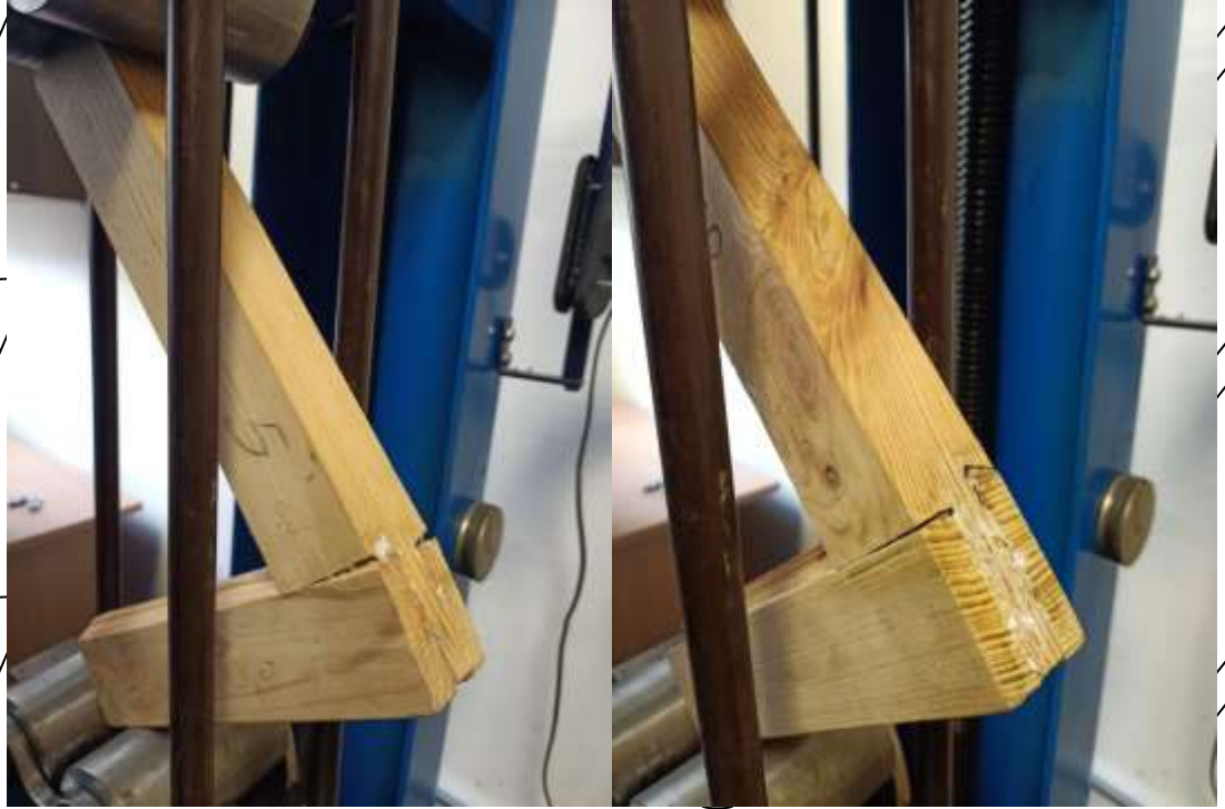
Рис. 3.21. Руйнування зразків типу «ПВА» та «рідке скло»
