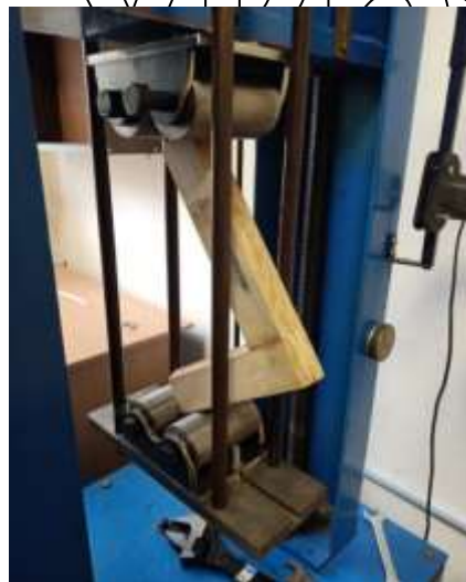
Рис. 3.18. Розміщення заготовки у випробувальній машині
