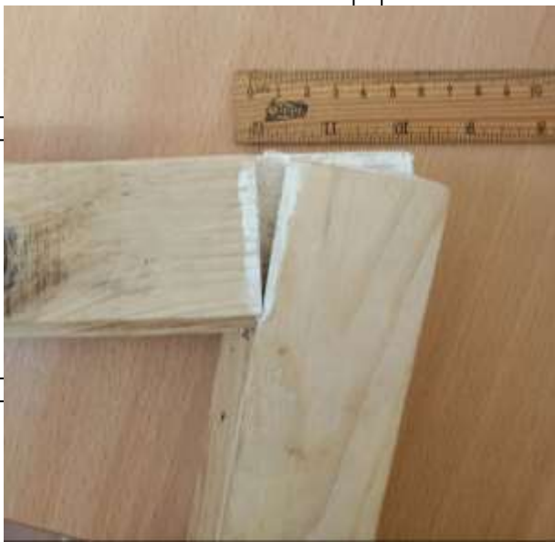
Рис. 3.31. Зруйнований зразок типу «бустилат»
