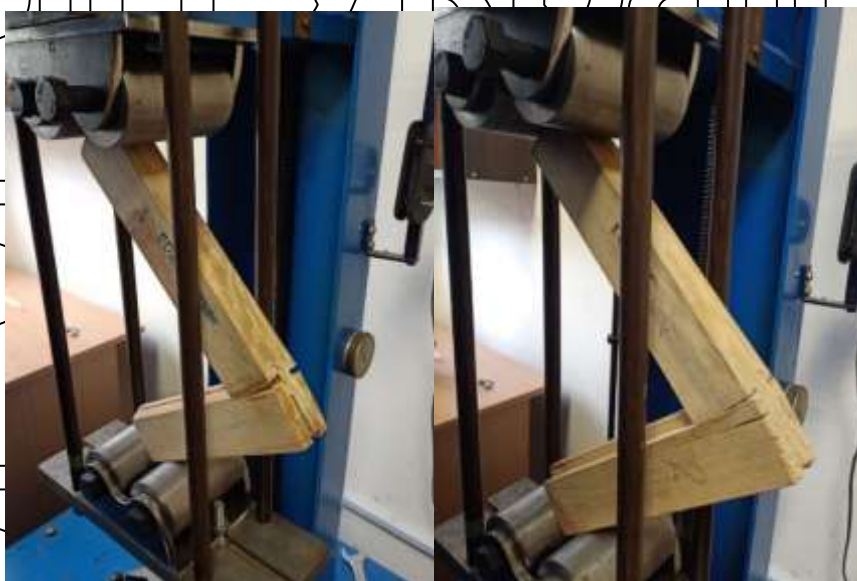
Рис. 3.20. Руйнування зразків типу «полесуритан» та «каучук» відповідно
