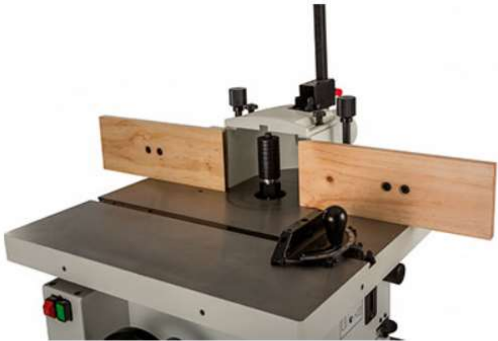
Рис. 2.3. Станок для фрезерування та вирізання пазів [48]
