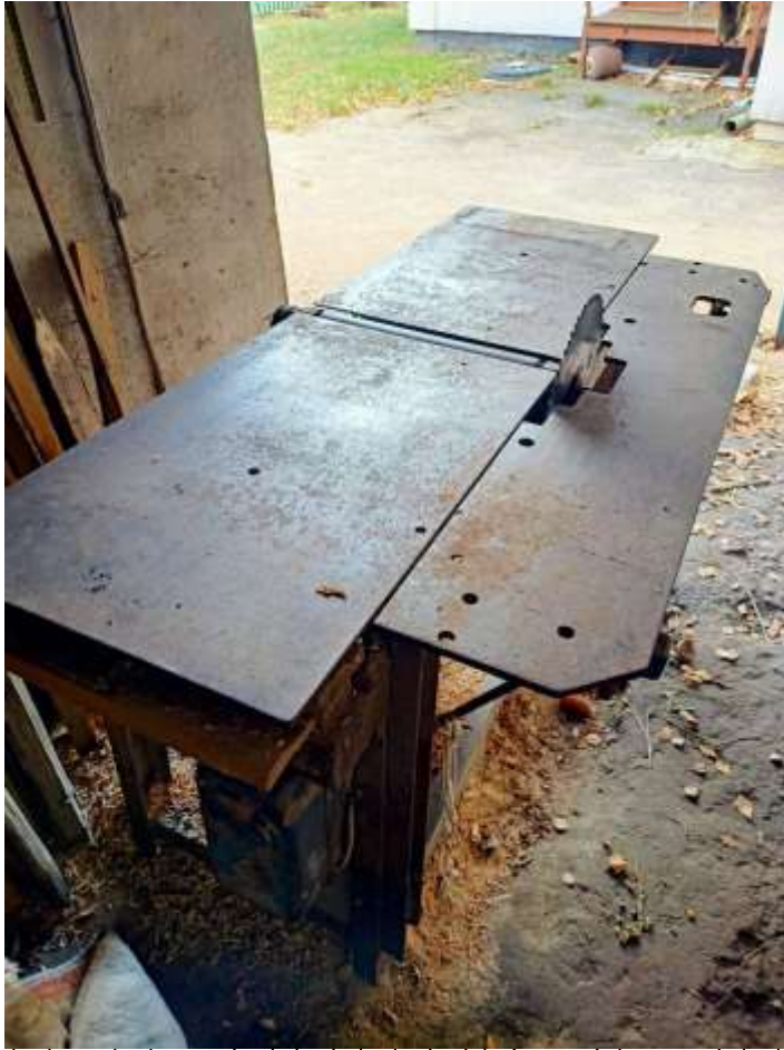
Рис. 2.2. Станок для вирізання та стругання заготовок.
