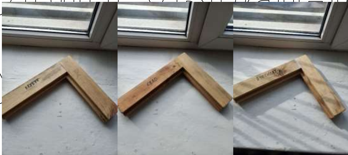
Рис. 3.13. Склеєні зразки каучуковим клеєм, клеєм «Бустилат» та рідким склом
