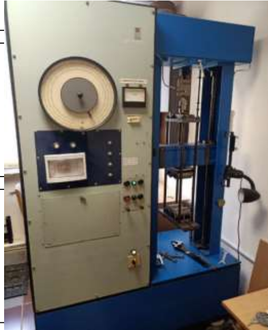
Рис. 3.17. Експериментальна руйнівна машина Р-5
