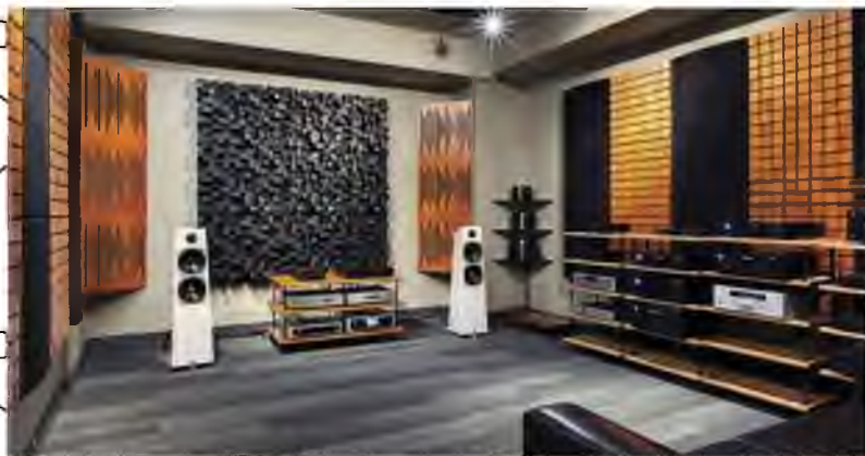
Рис 1.3. Приклад приміщення для прослуховування музики оснащеними акустичними панелями та дифузорами.
