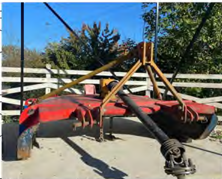
Рис. 4.7. Загальний вигляд подрібнювача «Kansas-170»
