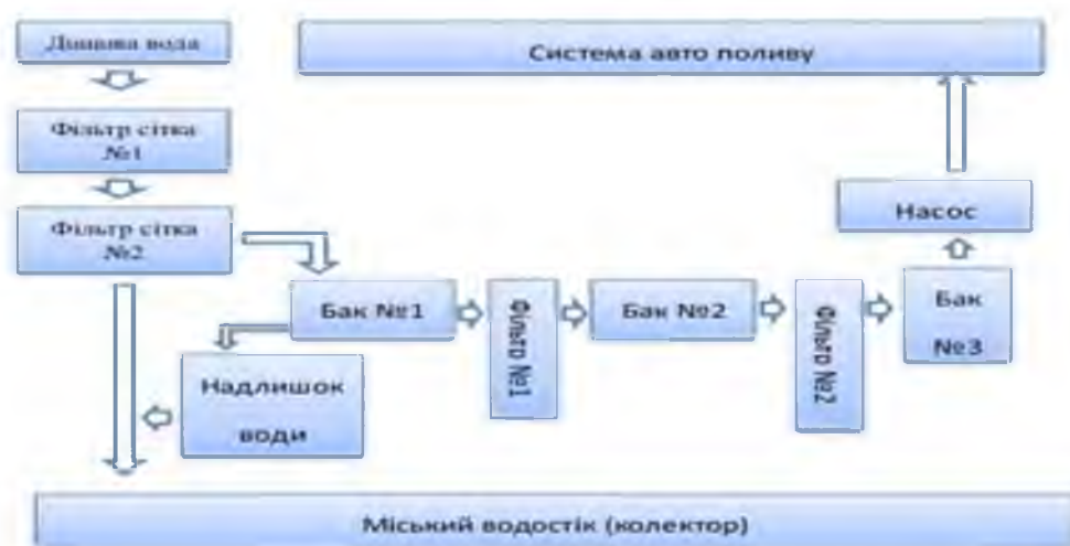
Рис. 5.3. Схема руху води та автономного забезпечення системи водою
