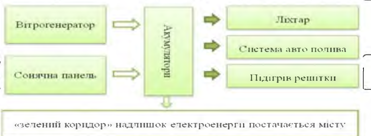
Рис. 5.4. Схема автономного забезпечення електроенергією
