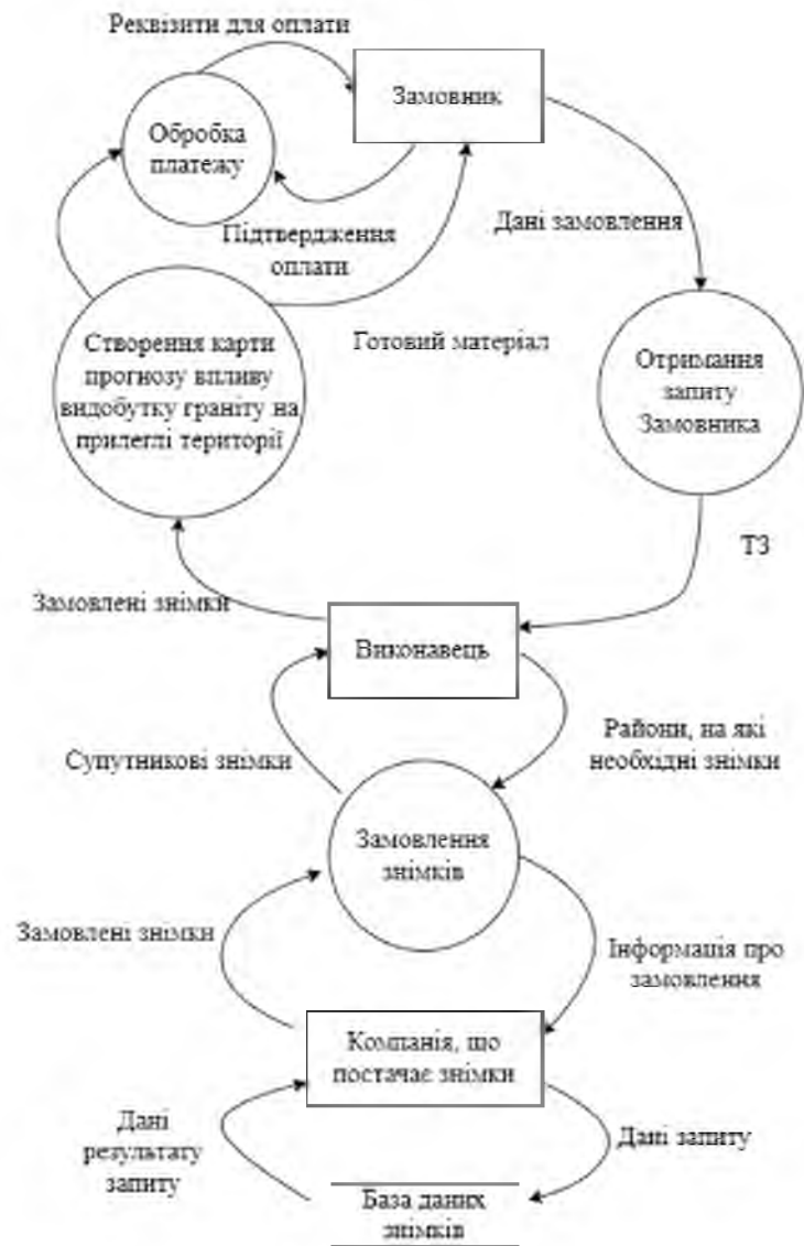
Рис.2.10 Концептуальна функціональна модель потоку інформації в процесі замовлення карти
