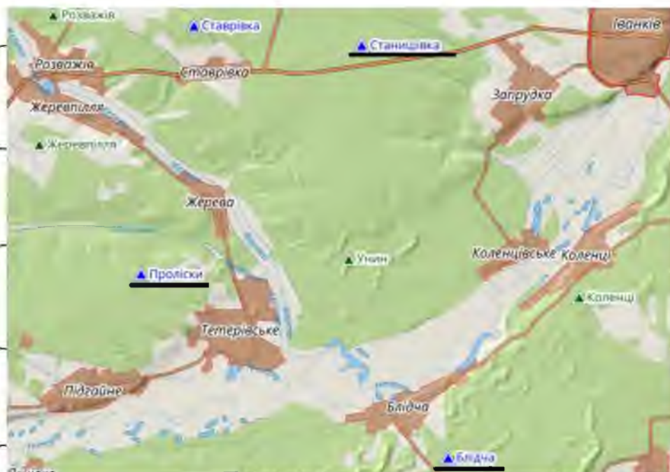
Рис. 3.2 – Схема розташування пунктів державної геодезичної мережі
