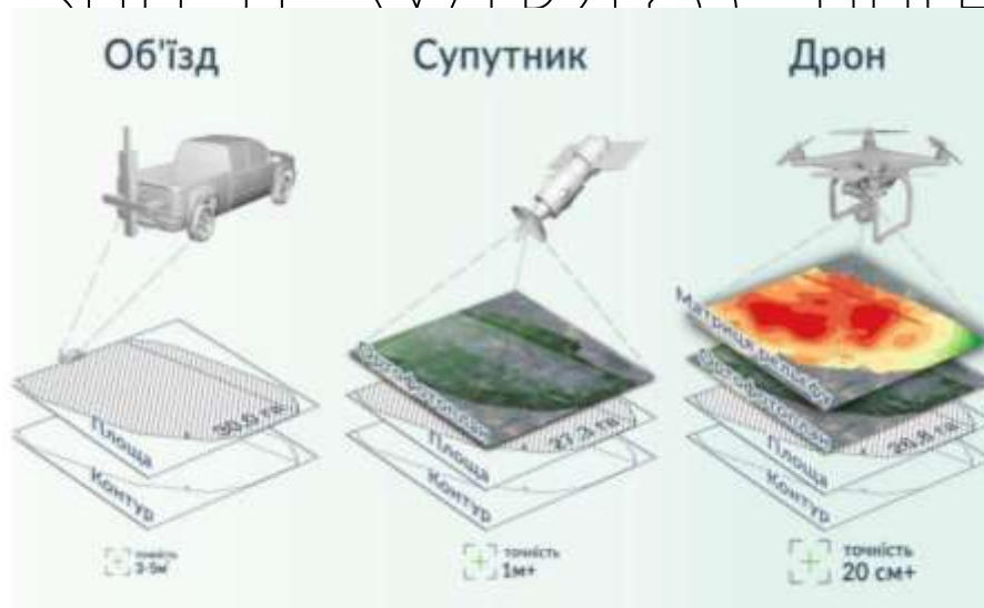
Рисунок 3.16. Переваги БПЛА серед інших видів вимірювання землі для потреб землеустрою
