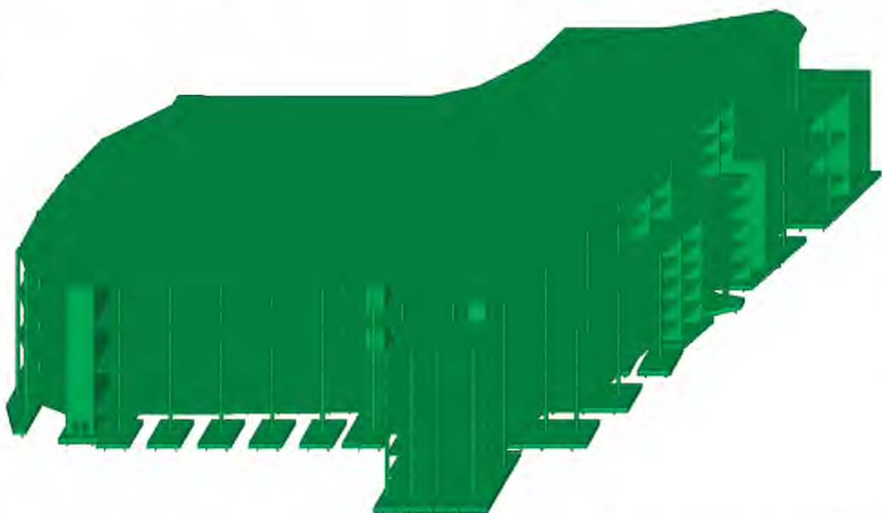
Д2. 3D моделювання будівлі в Мономах програмі
