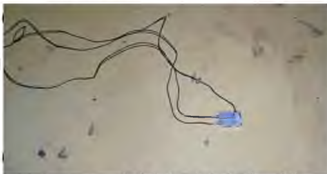
Фото 9.3. Розташування віброперетворювача на підлозі (точка ТВ)
