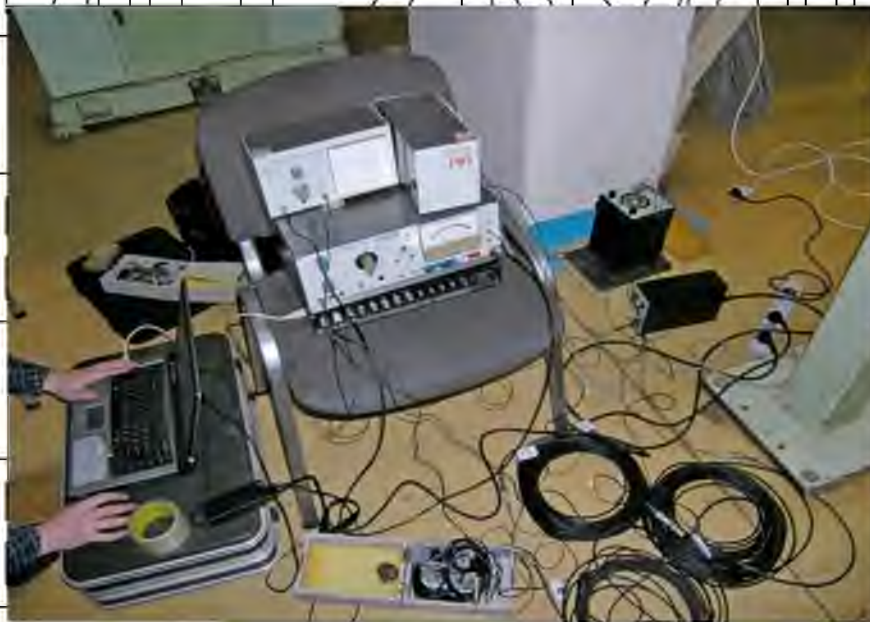
Фото 9.2. Апаратура та обладнання, що використовувалася для вимірювань вібраційного прискорення на елементах конструкцій
